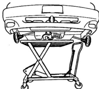
31. 拆下冲击杆和发动机架的螺母和螺栓。
